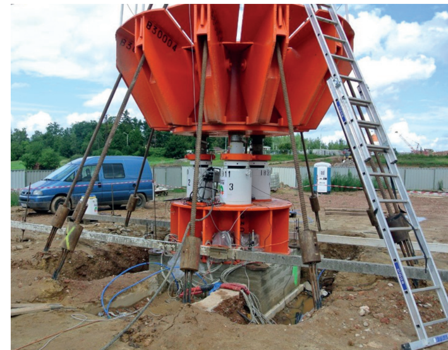
Zatěžovací zkouška zkušební lamely
